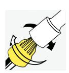
Un chasse-écrou de 13 mm (½ po) peut également être utilisé.
