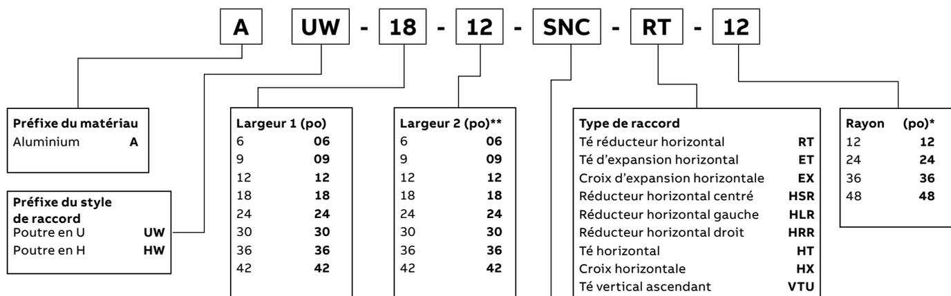
— Pour les types de raccords ET et EX, L2 > L1. Pour les types de raccords RT, HSR, HLR, HRR, L1 > L2.
