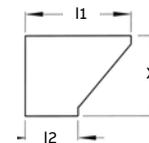
(†) Insérer la hauteur du rail latéral. (\*) Insérer le style de fond pour compléter le numéro de catalogue. Une paire d'éclisses à enclenchement est incluse avec la quincaillerie. Le chemin de câbles en aluminium T&B se décline en deux modèles distincts, le style en H et le style en U. Ceux-ci sont interchangeables.
