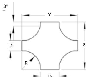
(+) Précisez la hauteur du rail latéral. (\*) Précisez le type de fond afin que le numéro de catalogue soit complet. (+) Précisez le rayon (12 po à 36 po). Trois paires d'éclisses à enclenchement sont incluses avec la quincaillerie.
