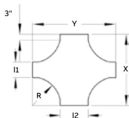
(†) Insérer la hauteur du rail latéral. (\*) Insérer le style de fond pour compléter le numéro de catalogue. (+) Insérer le rayon (12 à 48 po). Trois paires d'éclisses à enclenchement sont incluses avec la quincaillerie. Le chemin de câbles en aluminium T&B se décline en deux modèles distincts, le style en H et le style en U. Ceux-ci sont interchangeables.
