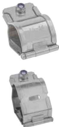
Conçues spécialement pour s'adapter aux échelons de chemins de câbles T&B en aluminium et en acier, les nouvelles brides en acier inoxydable 316 d'ABB serrent et soutiennent les câbles à l'intérieur du chemin de câbles. En cas de court-circuit, elles aident également à prévenir les dommages aux câbles, au chemin de câbles et au matériel environnant et réduisent les risques de blessures.
