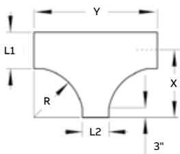
(t) Précisez la hauteur du rail latéral. (\*) Précisez le type de fond afin que le numéro de catalogue soit complet. (+) Précisez le rayon (12 po à 36 po). Deux paires d'éclisses à enclenchement sont incluses avec la quincaillerie.
