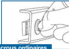
Le boulon enrobé d'adhésif pénètre l'écrou ordinaire avec un peu de résistance, ce qui permet la rotation de l'écrou lorsque le boulon est resserré. Placez l'écrou à l'horizontale.
