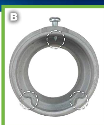
**Les nervures et les vis à filetage conique assurent un contact solide du mât en trois points**
